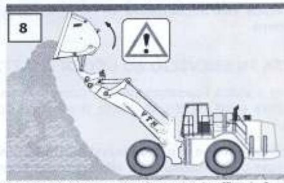
8\_ Fare attenzione a non sbattere nel soffitto in fase di scarico. Questa manovra può danneggiare i cilindri
