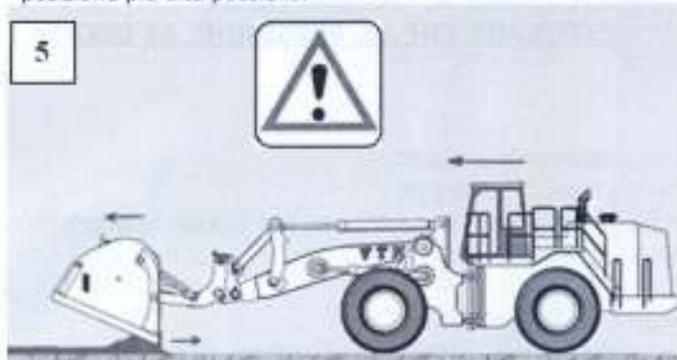
5\_ **NON** è consentito operare con l'attrezzatura in posizione aperta di scarico per livellare e spianare materiale o pulire superfici.
