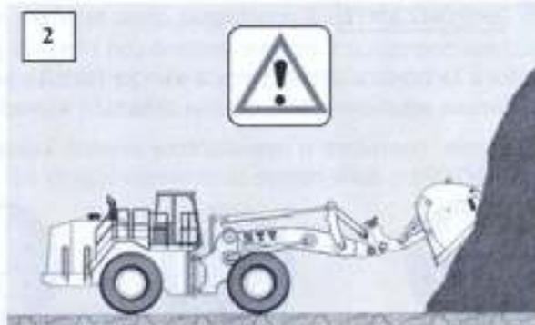
2\_ **NON** è consentito utilizzare l'attrezzatura in posizione aperta di scarico per la sistemazione del materiale, sia sul mucchio che a terra.
