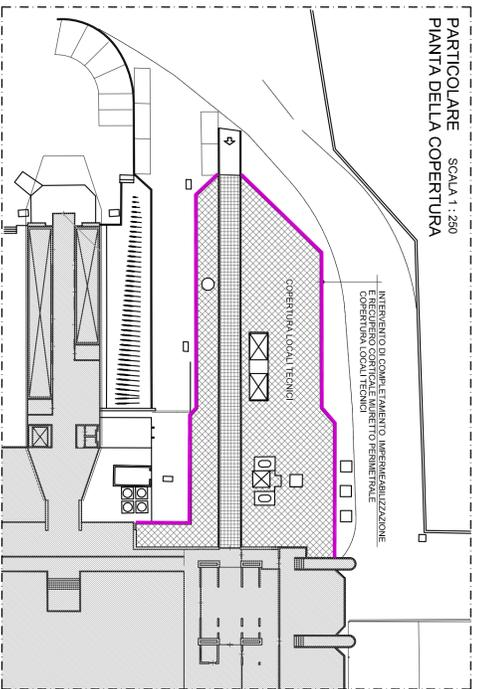
**PARTICOLARE COMPLETAMENTO IMPERMEABILIZZAZIONE E RECUPERO CORTICALE LOCALI TECNICI**
