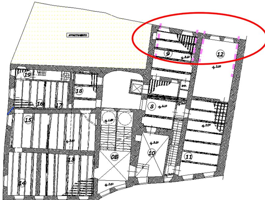
L'analisi di tali meccanismi di collasso locali è stata effettuata attraverso un'analisi cinematica lineare ed è stato preso in considerazione il meccanismo di ribaltamento semplice di parete e di flessione verticale..
