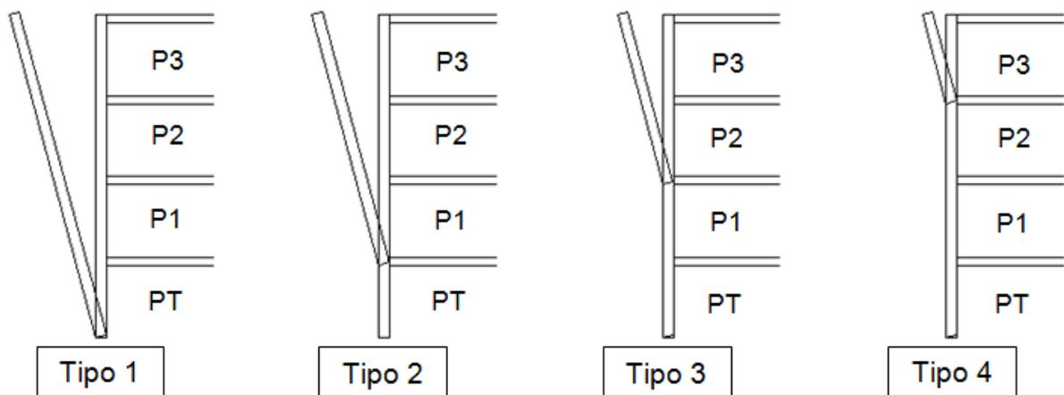
Il meccanismo di collasso di flessione verticale è stato analizzato con schema ad un piano riferendolo a ciascun piano costituente la parete.
