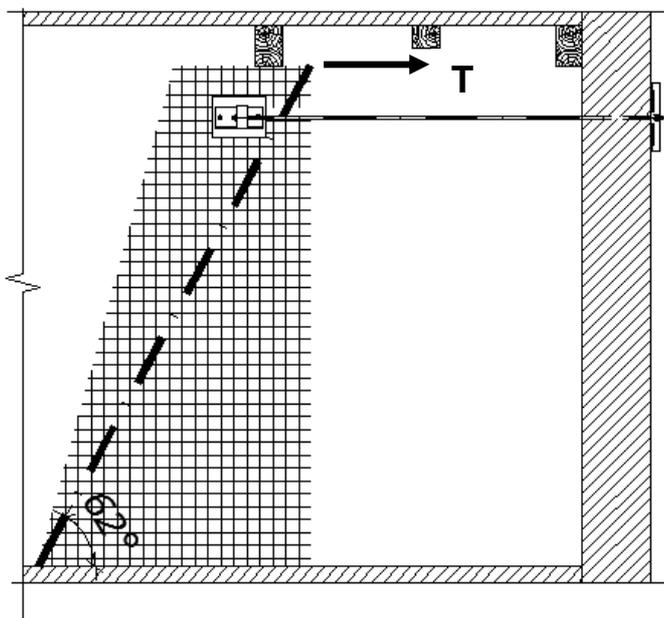
La verifica è effettuata considerando una striscia di rinforzo di larghezza pari al 25% della lunghezza della diagonale individuata; la sezione resistente ha un'armatura costituita da rete  $\Phi 5/10 \times 10$ .
