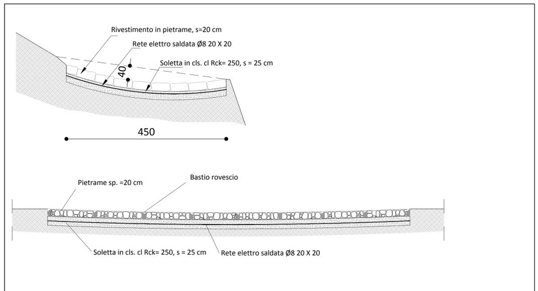
Basto rovescio, sezione trasversale e longitudinale lungo l'asse. Scala 1:50
