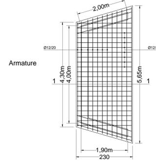
SEZIONE 1-1 MURO IN C.A., 1:50
