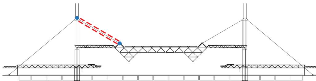
FASE 3: POSIZIONAMENTO E TESATURA STRALLI PROVVISORI
