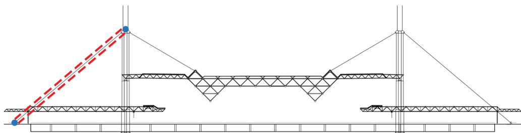
FASE 3: POSIZIONAMENTO E TESATURA STRALLI PROVVISORI
